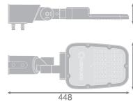
**Technische Daten Ledvance LED-Straßenbeleuchtung Area Value klein SPD Aluminium Grau 45W 5850lm 160x58D - 727 | IP66 - Symmetrisch**
