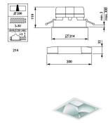
Technische Daten Philips LED Deckenstrahler LuxSpace Quadrat DN572B VLC-E 16.5W 2200lm 80D - 840 | 214mm - Aluminium Reflektor - Dali Dimmbar
